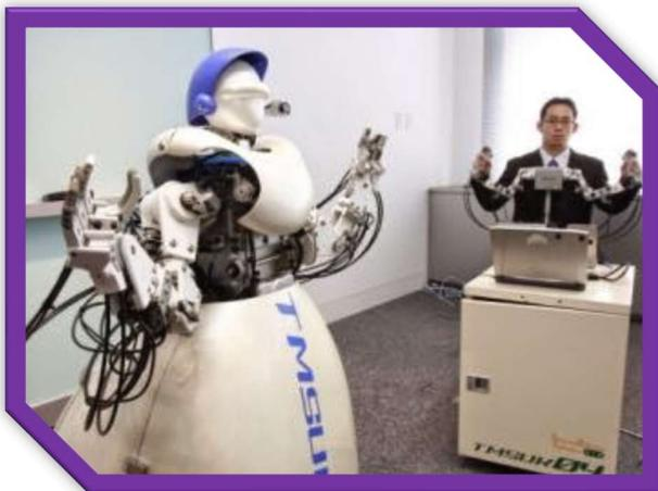
Un robot teleoperador es un robot controlado de manera remota por un operador humano.
